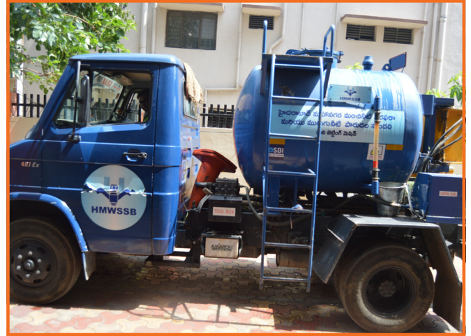
Figure 2 - Mini Sewer Jetting Vehicle
